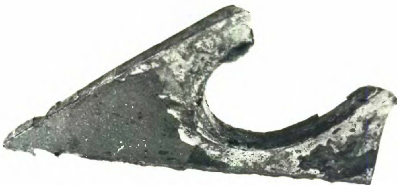
13 Põhjalukustusseadme purunenud kõrva detailid
