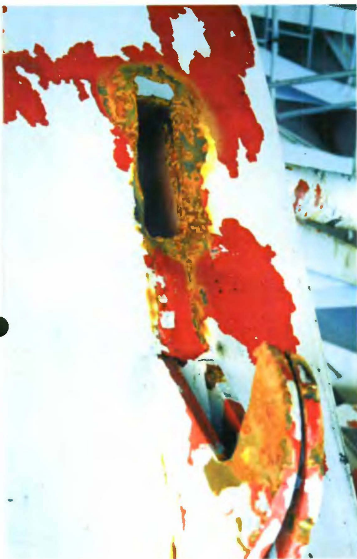
10.7 Külglukustuse kõrva eraldumisest põhjustatud kahjustused
