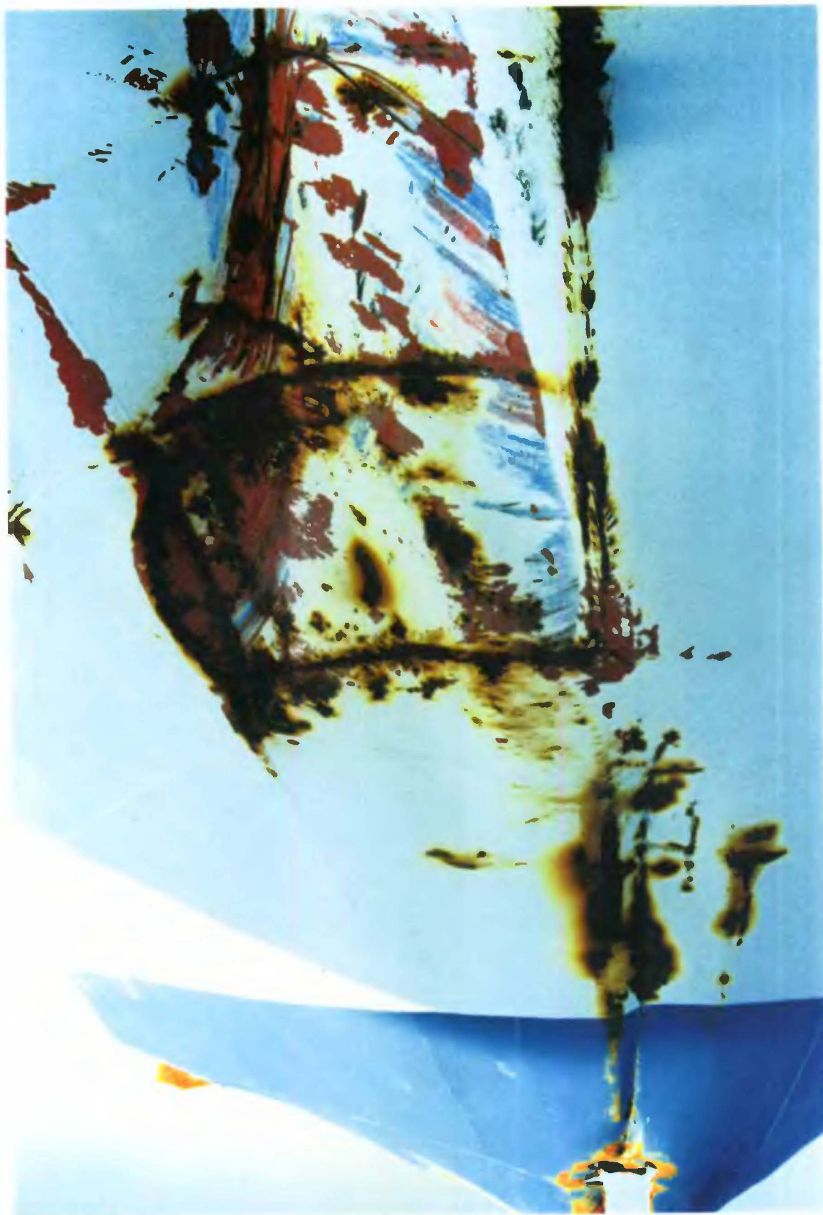
10.9 Visiiri esikülje vigastused, milles nähtub ka vöörtäävi eraldumine
