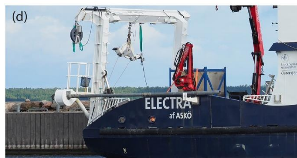
Foto M2. Uurimislaeva Electra põhjaproovivõtu süsteem. (a) Pinnasepuuril on parempardal käivitamissüsteem. Teki ahtriosas on kaasaskantav külmik puursüdämike hoiustamiseks. (b) 473 kg tinaraskustega lastitud pinnasepuuri pea. (c) Põhjaproovivõtu vints (InterOcean, mudel 10031-20HLW, hüdrauliline), varustatud 600 m ja 11,43 mm läbimõõduga trossiga (Rochester A302799). (d) Pinnasepuuri käitlemise süsteem. Fotod: Martin Jakobsson (a ja c on taaskasutatud varasematest reisiaruannetest). Fotod: Martin Jakobsson
