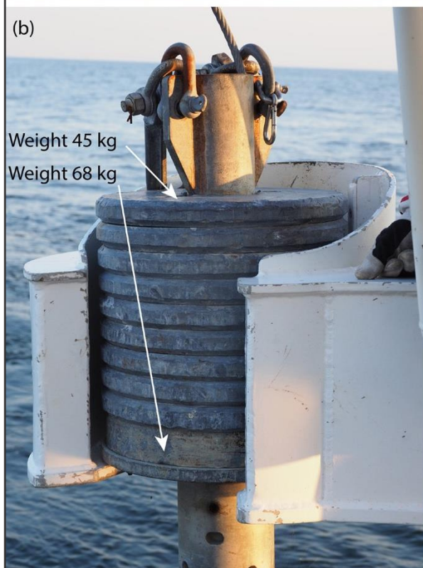
Foto M2. Uurimislaeva Electra põhjaproovivõtu süsteem. (a) Pinnasepuuril on parempardal käivitamissüsteem. Teki ahtriosas on kaasaskantav külmik puursüdämike hoiustamiseks. (b) 473 kg tinaraskustega lastitud pinnasepuuri pea. (c) Põhjaproovivõtu vints (InterOcean, mudel 10031-20HLW, hüdrauliline), varustatud 600 m ja 11,43 mm läbimõõduga trossiga (Rochester A302799). (d) Pinnasepuuri käitlemise süsteem. Fotod: Martin Jakobsson (a ja c on taaskasutatud varasematest reisiaruannetest). Fotod: Martin Jakobsson
