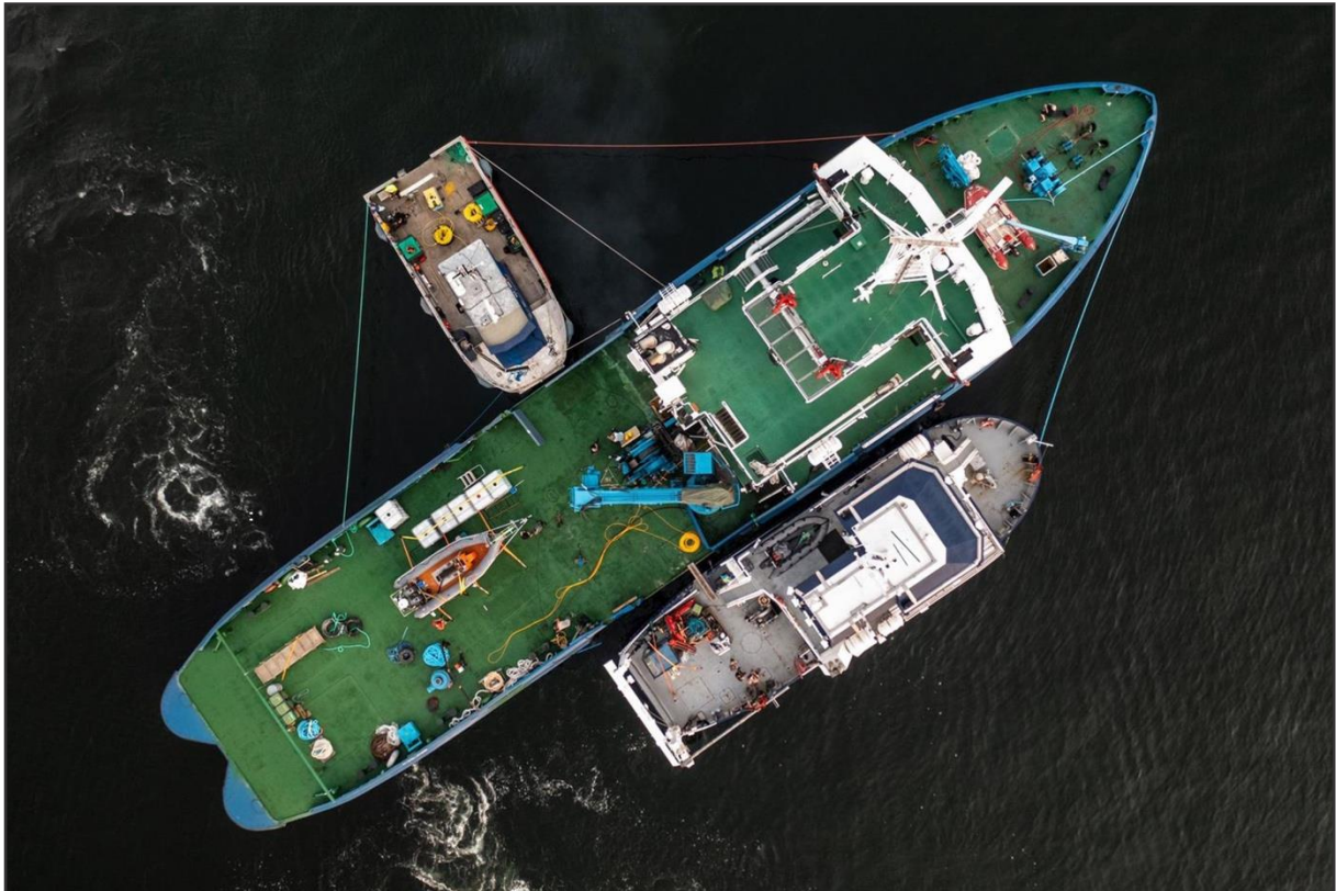
Foto 11. Aerofoto parvlaeva Estonia vraki uurimises osalenud kolmest laevast. Üleval: Subsurveyor VLT089, mida kasutatakse ROV (allveeroboti) kasutamiseks; keskel: 58 m pikkune Eesti jäälõhkuja EVA-316, mida kasutati varustuslaevana ja mida Abbott Acoustics kasutas platvormina parvlaeva Estonia akustiliseks pildinduseks skannimissonari abil; all: Stockholmi ülikooli 24 m pikkune uurimislav Electra, mis tegeles geofüüsikalise kaardistamise, geoloogilise põhjaproovivõtu ja okeanograafilise tööga. Foto: Madis Veltman, Postimees
