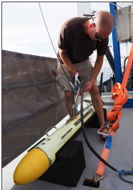
Foto M6. Külgvaatesonar, mida veetakse peamisel põhjaproovivõtu vintsi trossil ja eraldi signaaltrossiga. Foto: Martin Jakobsson
