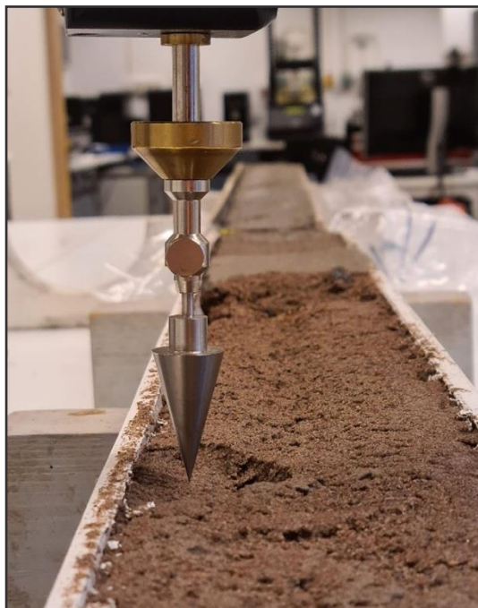
Joonis M6. Koonuspenetratsiooni seadistus, kujutatud enne koonuse vabastamist setetes.
