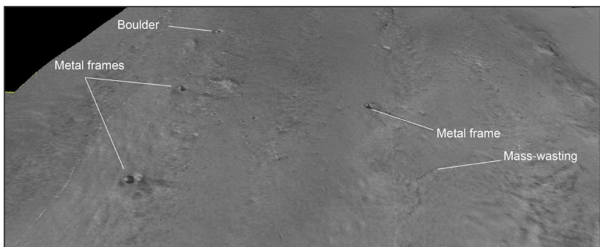
Joonis SBI18. Tagasihajumise kujutise 3D-vaade paljukiirelise batümeetria kohal alas, kus parvlaevast Estonia põhja pool asuvad metallraamid.
