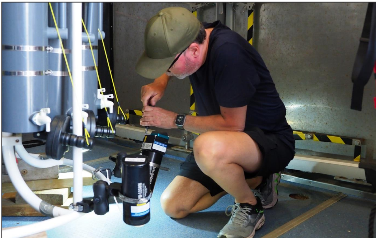
Foto M4. GoPro Hero 7+ kaamera ja valgusti on pandud veekindlatesse korpustesse ja paigaldatud CTD-karusselli raamile. Põhja analüüse tehti kas piki CTD-jäljendeid või karusselli merepõhjale langetamisega. Foto: Martin Jakobsson
