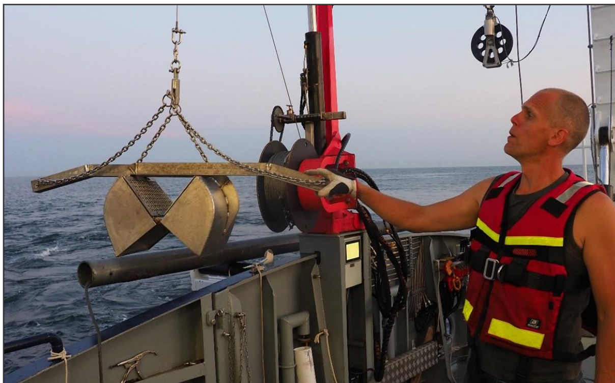
Foto M3. Van Veeni haaratsiga proovivõtja, mida kasutati häiritud pinnaselt setteproovide võtmiseks põhja kiireks iseloomustamiseks. Foto: Martin Jakobsson
