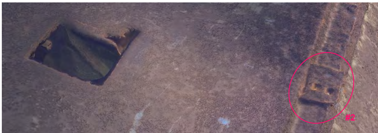
Joonis 3. Tuukrite lõigatud vööripoolne ava (vasakul) ja terasplaat #2 (paremal) vraki fotogramm-meetrilisel mudelil (2022). Allikas: Ohutusjuurdluse Keskus
