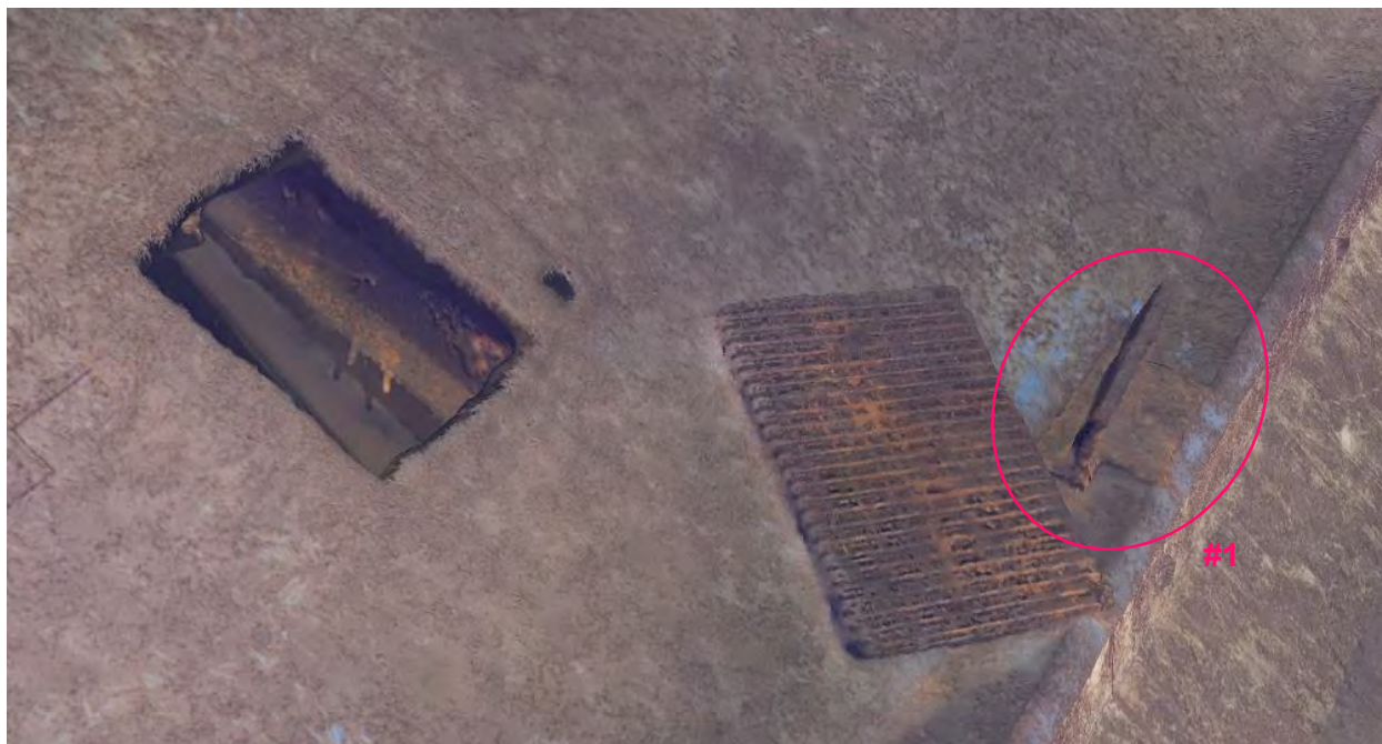
Joonis 2. Tuukrite lõigatud ava laeva keskosas (vasakul), paigast nihkunud ava katterest (keskel) ja terasplaat #1 (paremal) vraki fotogramm-meetrilisel mudelil (2022). Allikas: Ohutusjuurdluse Keskus
