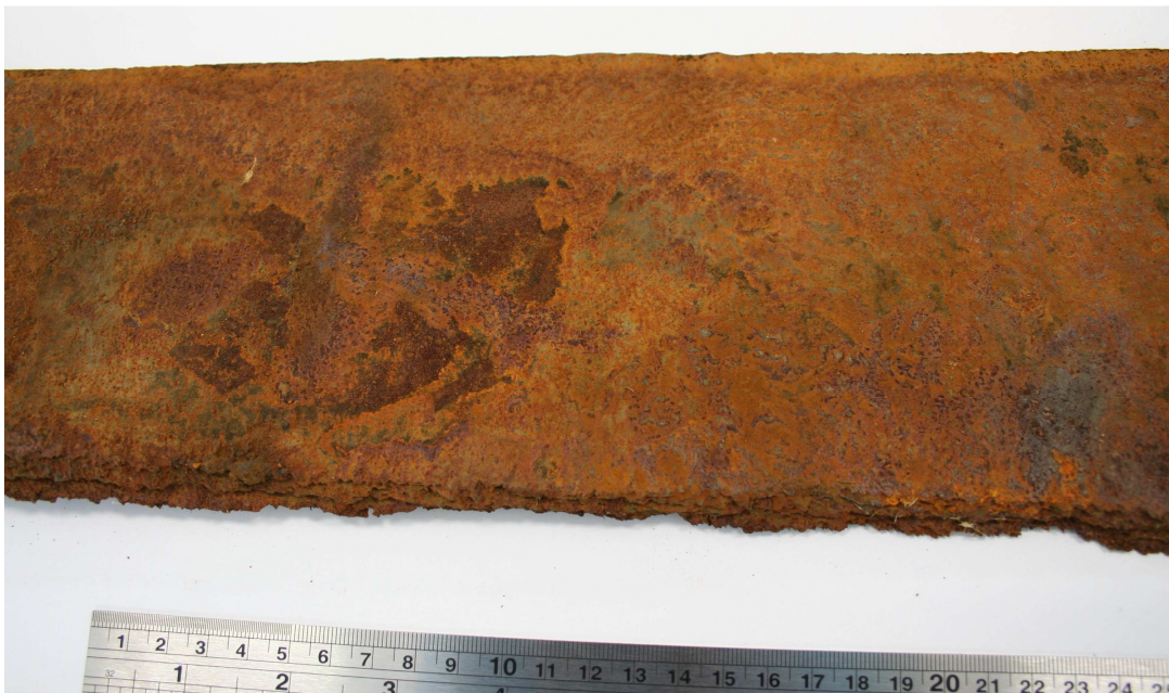
Pilt 4 metalliriba rebenenud serv, laevakere väliskülje vaade.
