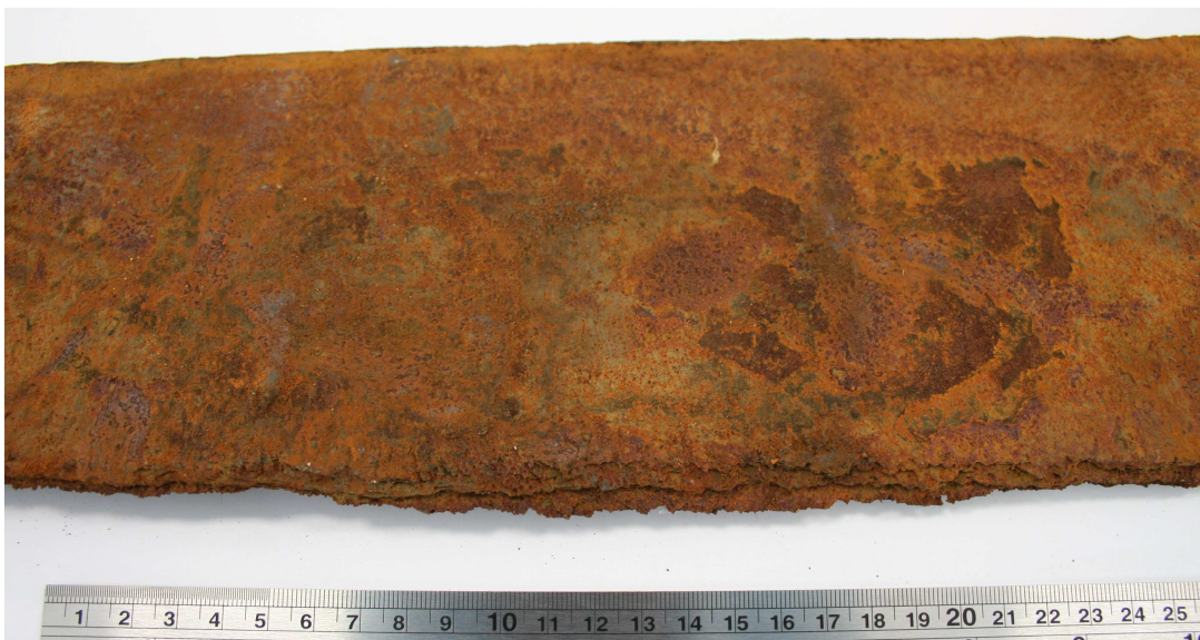
Pilt 5 metalliriba rebenenud serv, laevakere väliskülje vaade.
