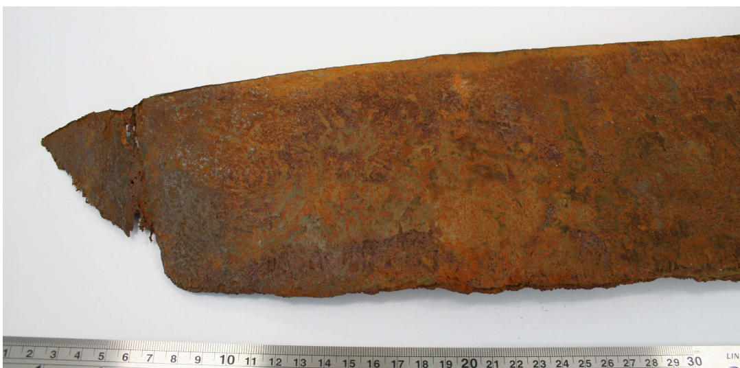
Pilt 6 metalliriba rebenenud serv, laevakere väliskülje vaade.
