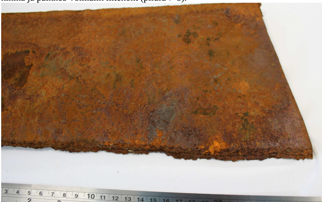
Pilt 3 metalliriba rebenenud serv, laevakere väliskülje vaade.
