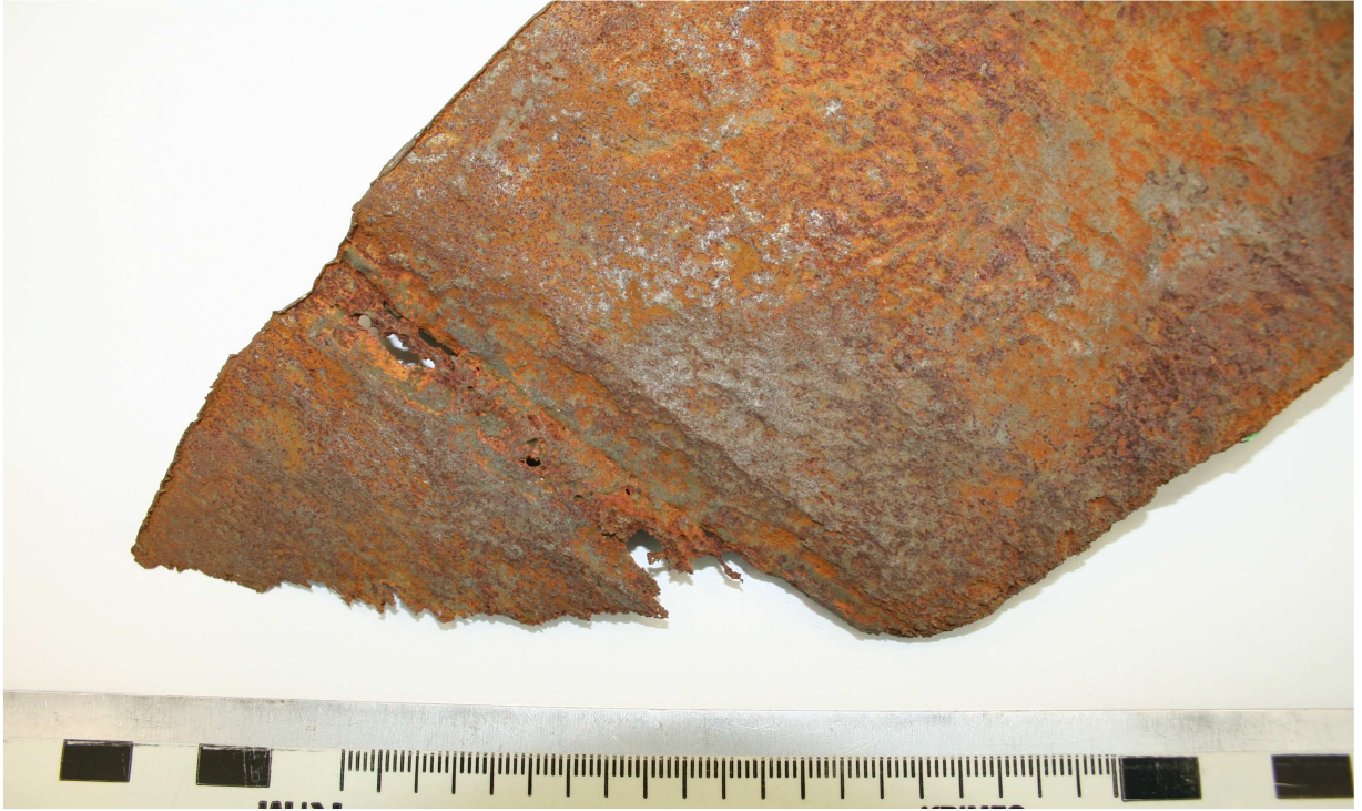
Pilt 7 metalliriba rebenenud serv, laevakere väliskülje vaade, võimalik liitekoht.
